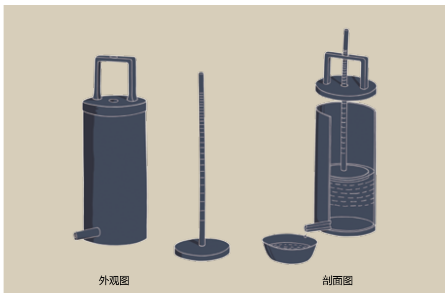
沉箭式陶漏壶使用示意图 The Usage Map of Dripping Pot
